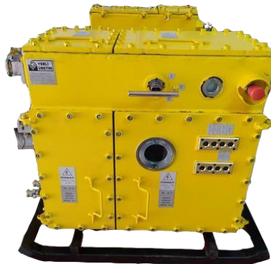
Görsel2: HALA315 Motor Çalıştırma Ünitesi
